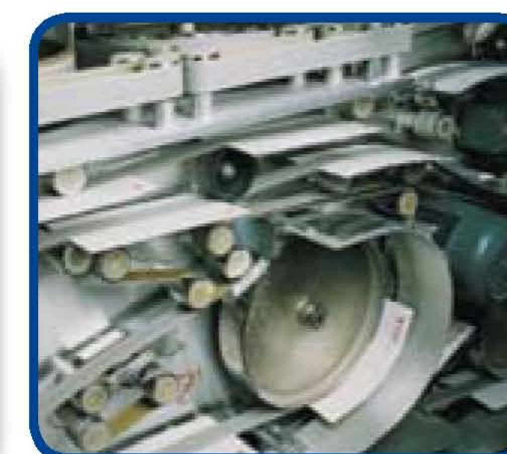
nastri macchina e smistamento lettere layboy tapes for paper printing letter sorting
